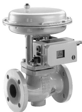
Slika 5 · i/p-regulator položaja tipa 3730-1 neposredna montaža na rebro NAMUR pogona tipa 3271
