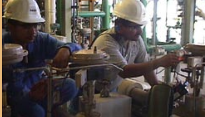
Le valvole di regolazione per Altamira vengono montate ed ispezionate nella filiale SAMSON messicana.
