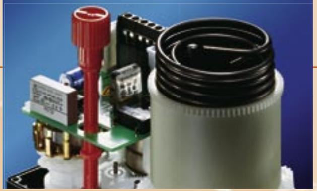
Los compactos accionamientos eléctricos de SAMSON incluyen finales de carrera por momento de torsión y posición de seguridad.
