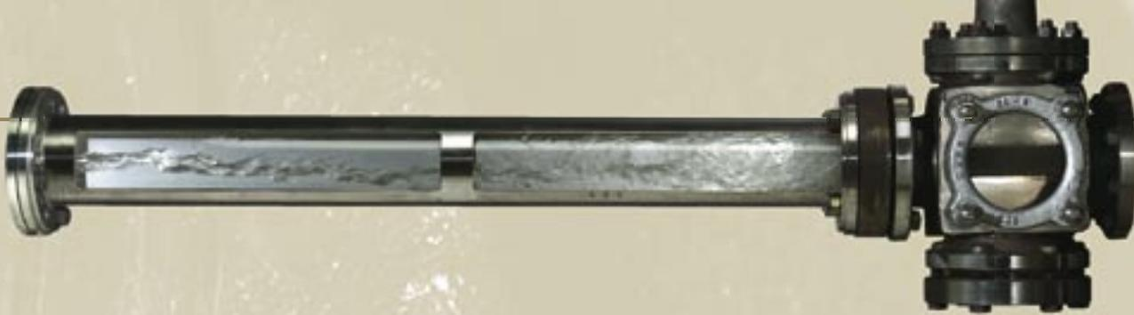
El banco de pruebas para flashing sirve para analizar los efectos de erosión y ruido del caudal en dos fases.
