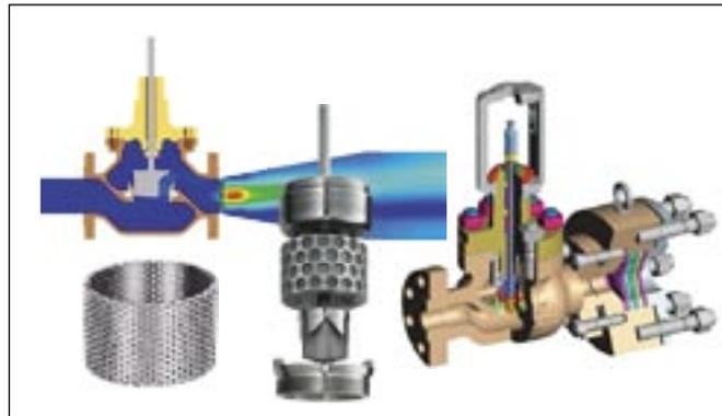
Bild 3: Möglichkeiten zur Schallreduzierung bei Gasen und Dämpfen (Strömungsteiler und nachgeschaltete Drosselemente)
