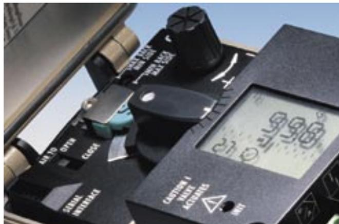
Bild 8: Stellungsreglerdisplay zur Vor-Ort-Anzeige von Parametern und Fehlerstatistik
