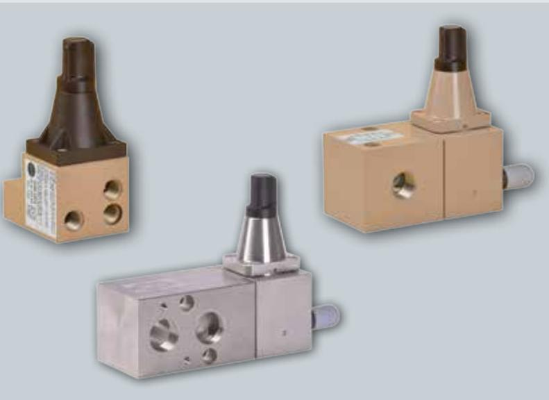
Los relés de bloqueo se utilizan para bloquear la tubería de presión de mando de los accionamientos neumáticos. Cierran la conducción de la presión de mando de la válvula de control cuando la presión de alimentación falla o no alcanza un valor previamente ajustado. El accionamiento permanece en su última posición.
