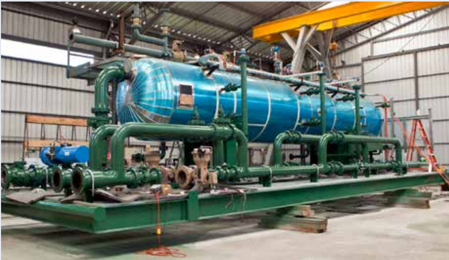
Typischer Dreiphasen-Ölabscheider, ausgestattet mit SAMSON-Ventilen
