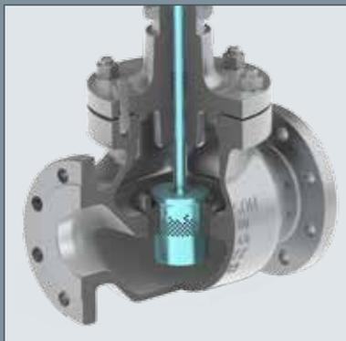
Les clapets perforés sont principalement utilisés sur des applications vapeur, notamment en conditions de vapeur humide. Egalement sur fluides diphasiques, applications liquides avec vaporisation en sortie (vannes flashing) et les vannes de sécurité de mise à l'atmosphère (vannes de purge) avec détentes de gaz pour lesquelles la vitesse ne peut pas être maintenue  $\leq$  à Mach 0.3.
