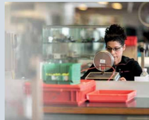
« Je travaille sur les électrovannes type 3963. Je m'occupe précisément du réglage et de l'étalonnage des bobines qui composent les électrovannes dont je gère aussi l'assemblage. Au quotidien, je manipule de très petites pièces, avec une pince à épiler par exemple. Par conséquent, il faut faire preuve de patience et de concentration. Mes gestes sont très précis. J'apprécie le calme et le fait d'être autonome sur mon poste, en gérant la bobine du début à la fin. »
