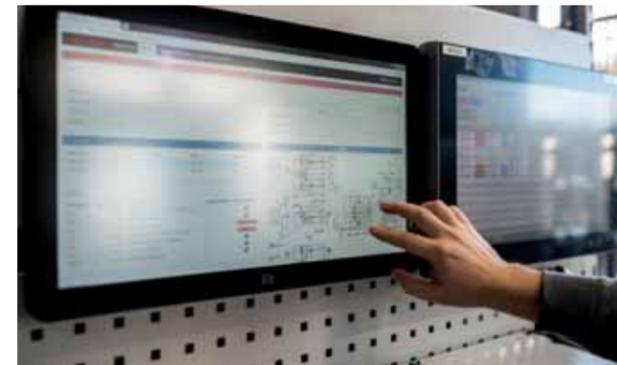
« Il faut analyser les données sur une période de plusieurs mois pour que ce soit pertinent. Nous les exploitons notamment sur cette cellule de fraisage. Ça nous permet d'observer l'efficacité de la machine (temps effectifs d'usinage, d'arrêts, de maintenance) et de synthétiser les commentaires des opérateurs afin d'apporter des améliorations. Et ce, en vue d'une plus grande productivité. »
