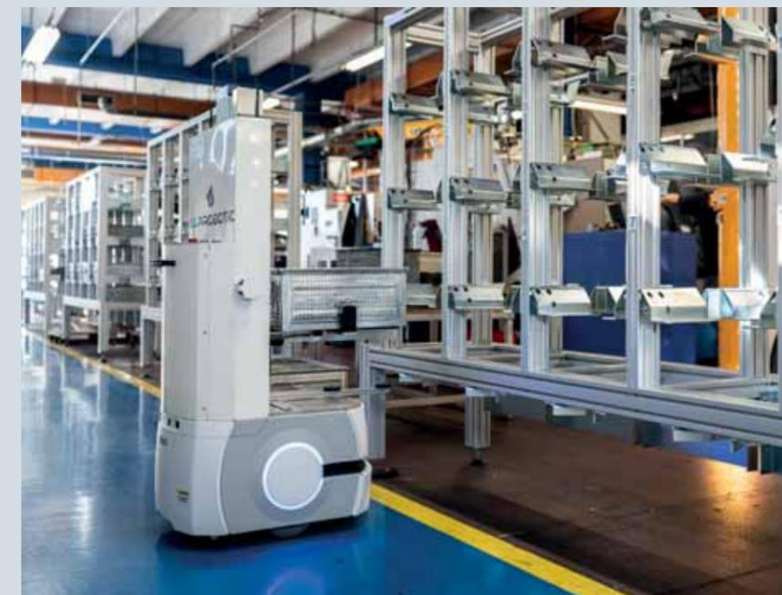
**Alimentation d'une cellule d'usinage robotisée. SAMROB va approvisionner, à terme, la totalité du parc de machines afin d'assurer une production en continu.**
