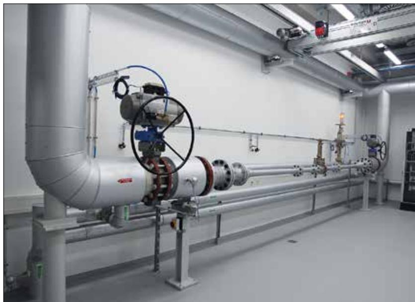
*In diesem Flow Lab werden die Funktionen von Reglern ohne Hilfsenergie als eigenständige Komponenten in simulierten Fernwärmenetzen getestet: Ventilgrößen DN 15 bis 300 bei Dampf mit einer Temperatur von 230 °C bis 13 bar Druck und einer Durchflussrate von 5000 kg/h*
