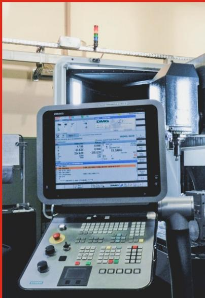
Über jeder Maschine signalisiert eine Signalsäule schnell und eindeutig den Status.
